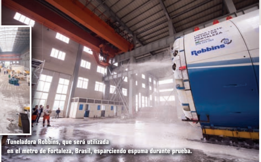
Cuatro tuneladoras Robbins de casi 7 metros de diámetro estarán participando de los trabajos del Metro en la ciudad de Fortaleza.
