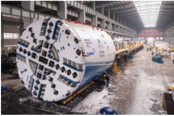
Cuatro tuneladoras Robbins de casi 7 metros de diámetro estarán participando de los trabajos del Metro en la ciudad de Fortaleza.
