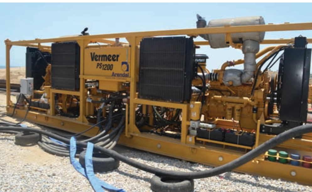
A perfuratriz D1000x900R da Vermeer se alimenta de uma fonte de potência PS1200.
